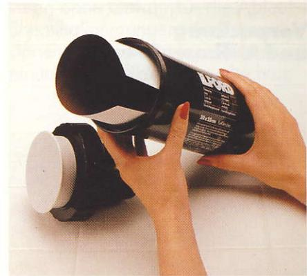
5. Belichtetes Blatt mit Schichtseite nach innen im Dunkeln in die Entwicklungstrommel einlegen. Trommel schließen.
