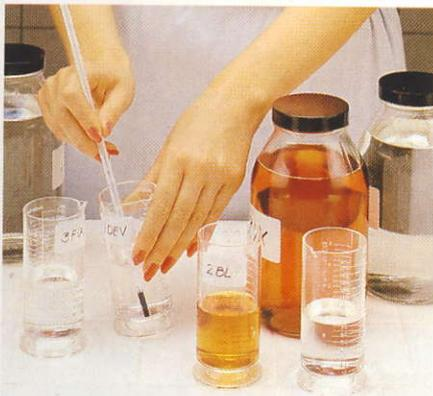
6. Licht einschalten. Von jedem der drei Bäder 75ml ausmessen und temperieren. Dazu 100ml Wasser bereitstellen und temperieren (24°C).
