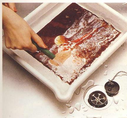
9. Das verarbeitete Bild vorsichtig aus der Trommel nehmen und in einer Schale 3 Minuten lang mit fließendem Wasser wässern.
