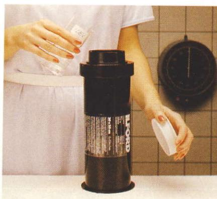
7. Den Entwickler in die Trommel eingießen, Trommel auf eine horizontale Fläche legen und 3 Minuten lang hin- und herrollen. Desgleichen 30 Sekunden spülen, dann 3 Minuten bleichen und 3 Minuten fixieren.
