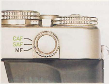
Griffiger **Wählknopf** für die Funktionen **CAF/SAF/MF** auf der Kamerarückseite. Beim Drücken des Knopfes wird in Stellung MF anstelle der Verschlusszeit die Entfernung in Meter/Zentimeter im Sucher angezeigt. In Stellung CAF/SAF kann mit einem Druck die Entfernung gespeichert werden.
